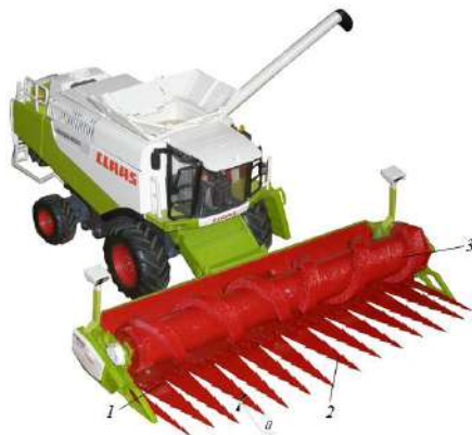
Рисунок 2 – Макет модернизированной жатки Vario 900: 1 – сегменты; 2 – делители; 3 – шнек
