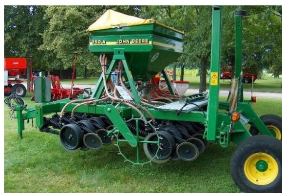
Рисунок 2 – Пневматическая сеялка John Deere 750 А, предназначенная для посева зерновых культур по минимальной и нулевой технологиям обработки
