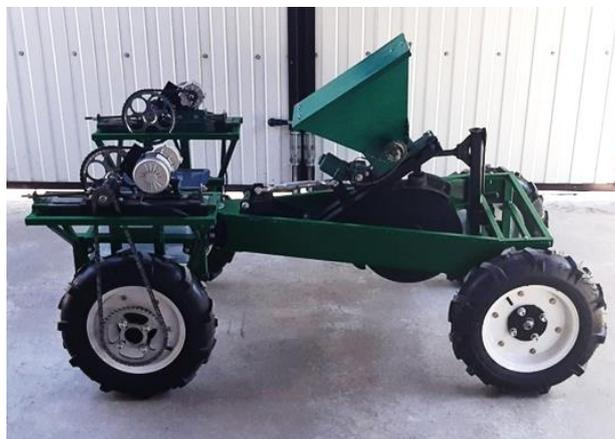
Рисунок 1 – Экспериментальный образец мобильного робота
