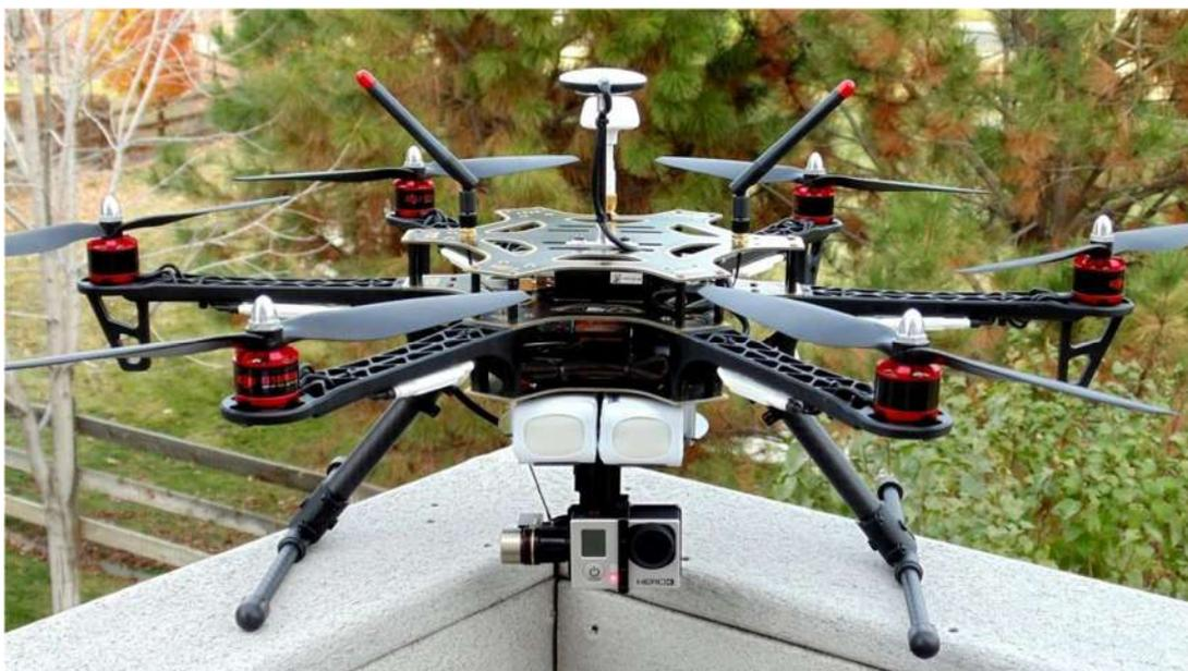
Рисунок 1 – Дрон для лазерного сканирования с воздуха
