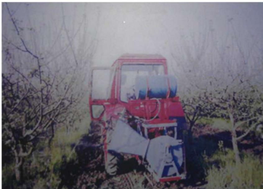
Рисунок 1 – Ультрамалообъемный вентиляторный опрыскиватель
