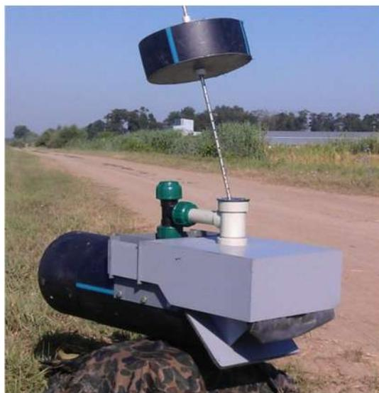
Рисунок 1 – Чековий регулятор уровня конструкции В. Т. Островского и Н. В. Островского (конструкция регулятора в сборе)
