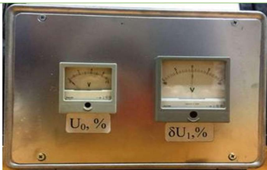
Рисунок 1 – Внешний вид прибора для измерения относительных значений отклонения напряжения прямой последовательности и напряжения нулевой последовательности сети 0,4 кВ
