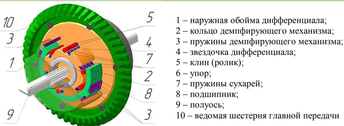
Рисунок 1 – 3D модель дифференциала
