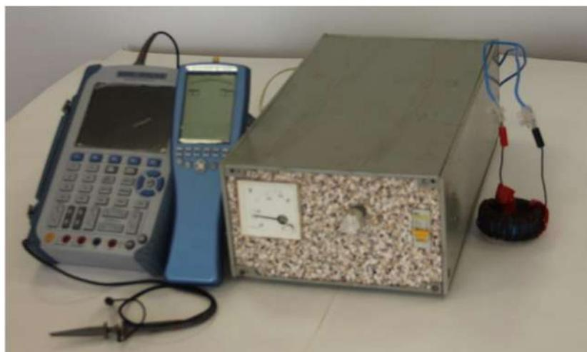
Рисунок 1 – Установка для обработки мясного сырья и стартовых культур ЭМП НЧ
