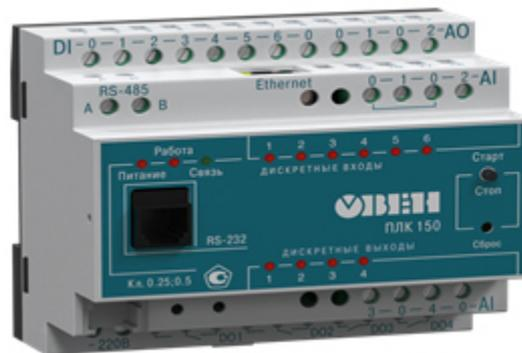
Рисунок 3.27 – Контроллер ОВЕН ПЛК150-24.А-М
