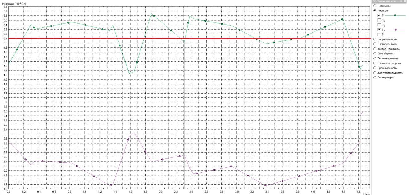
Рисунок 4.18 – График зависимости индукции от длины рабочей зоны акусто-магнитного аппарата по результатам моделирования и опыта
