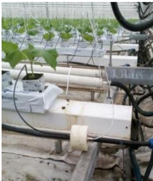
Рисунок 4.13 – Акусто-магнитный аппарат, установленный в систему подачи гидропонного раствора
