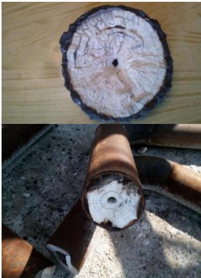
Рисунок В.5 – Изображение разрез трубы до установки аппарата
