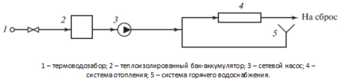
Рисунок 1.7 – Схема теплоснабжения параллельной подачи термальной воды на отопление и горячее водоснабжение [7]
