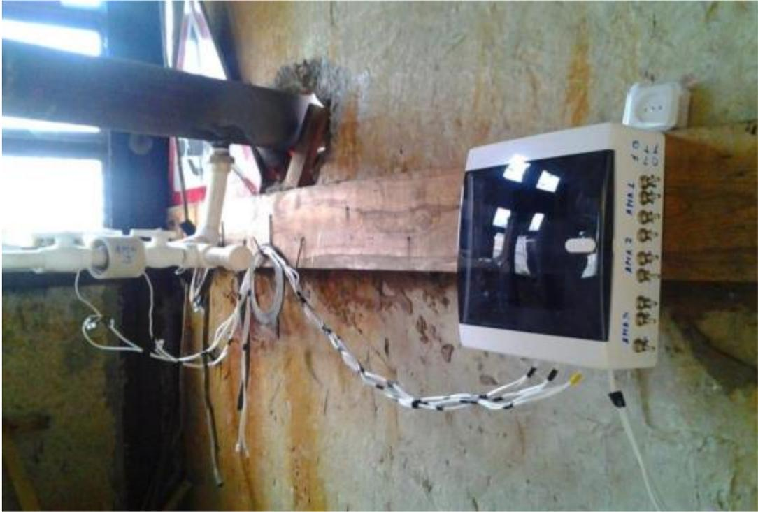
Рисунок В.3 – Общий вид системы акусто-магнитной обработки жидкости
