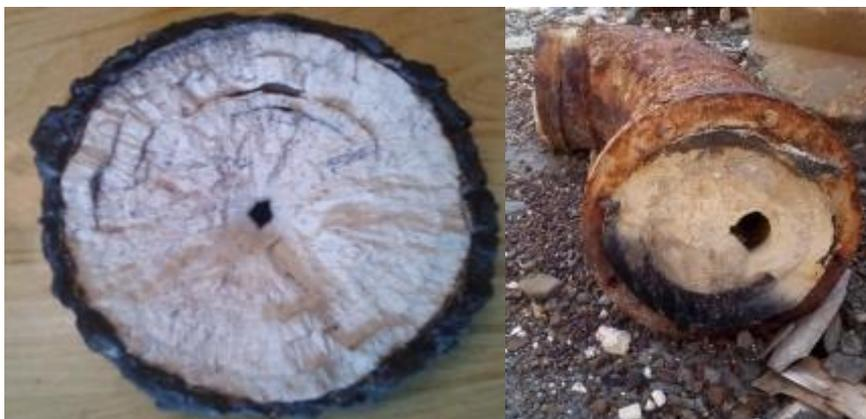
Рисунок 4.10 – Разрез труб, по которым протекали необработанные термальные воды
