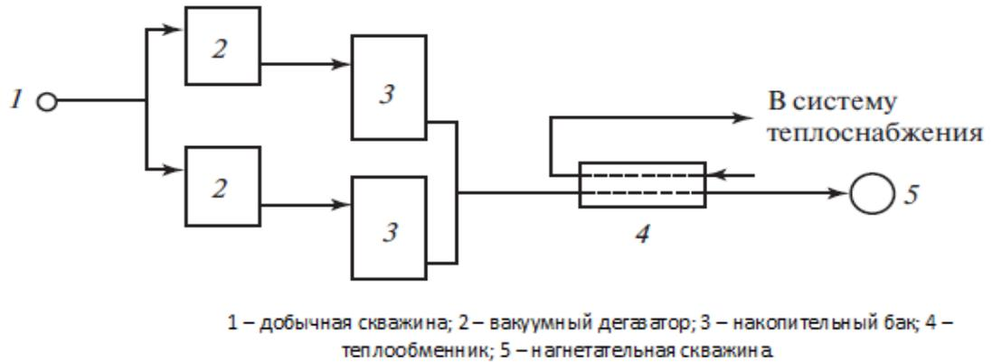
Рисунок 1.6 – Схема подготовки термальных вод, склонных к солеотложению [7]
