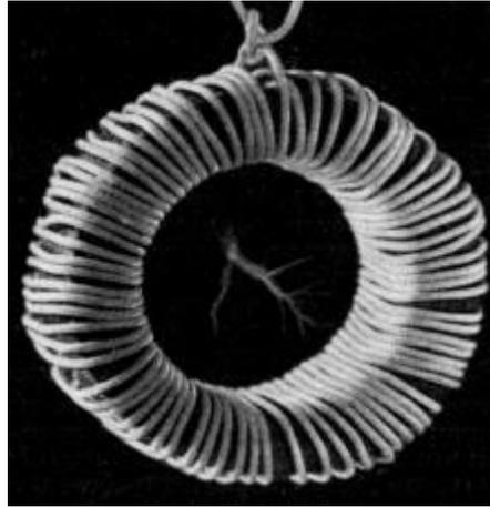
Рисунок 2.13 – Кавитационные тяжи в поле кольцевого ферритового излучателя
