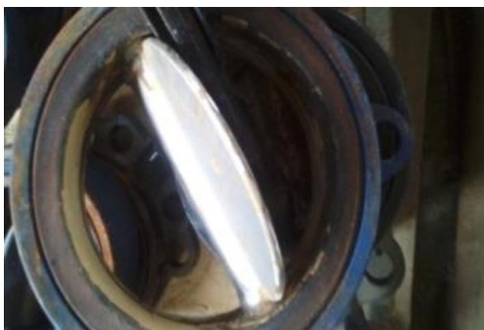
Рисунок В.6 – Изображение состояния заслонки после установки аппарата
