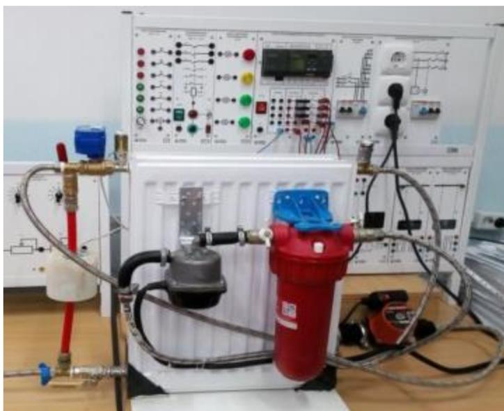
Рисунок 4.1 – Общий вид экспериментальной установки для определения эффективности акусто-магнитных аппаратов обработки воды
