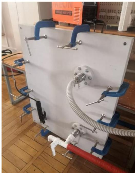
Рисунок 3.2 – Проточный диафрагменный электролизер воды, разработанный на кафедре электрических машин и электропривода Кубанского ГАУ
