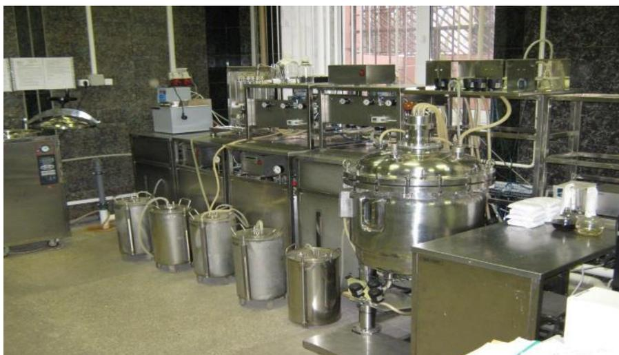
Рисунок 3.21 – Общий вид ферментационного комплекса ОКА МФ-100
