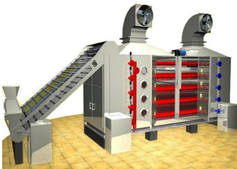
Рисунок 1.3 – Внешний вид паровой конвейерной сушилки ПКС-90
