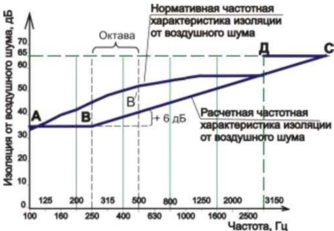
Рисунок 1 - Схема к расчету звукоизоляции перегородки
