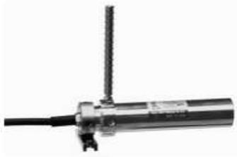
Датчики сдвига KU-A используются для измерений смещения при сдвиге между бетонной облицовкой тоннеля и грунтом. Датчик устанавливается на анкерный болт, который вворачивается в облицовку тоннеля.
