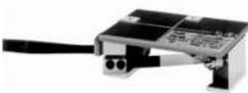
Двухкомпонентный датчик раскрытия трещин используется для одновременного измерения перемещений по двум осям: перемещение от развития трещин, а также горизонтальное смещение сдвига. Датчик устанавливается на специальную монтажную пластину. Пластина легко демонтируется, что позволяет оперативно применять данный датчик для различных задач.
