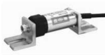
Датчики раскрытия трещин KG-A устанавливаются на поверхности бетонной конструкции поперек концентраторов напряжений или трещин для измерения величины раскрытия. Датчики водонепроницаемы, что позволяет проводить долговременные измерения. Они монтируются при помощи анкерных болтов (KGF-11) или зажимного приспособления (KGF-31).
