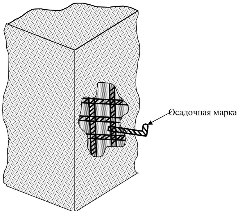
Схема установки осадочной марки
