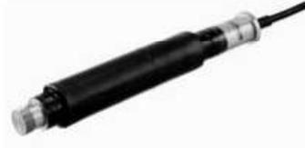
Датчики смещения KJA-A/KJB-A предназначены для измерений относительного смещения в швах, стыках, а также величины раскрытия трещин. Они устанавливаются на стыки бетонных плит или монтируются между плитами для мониторинга относительного смещения. Возможно водонепроницаемое исполнение данными серий датчиков, а также исполнение со встроенными термопарами.
