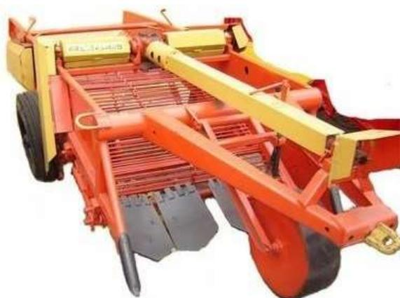
**Картофелекопатель полуприцепной двухрядный КСТ-1,4А**
