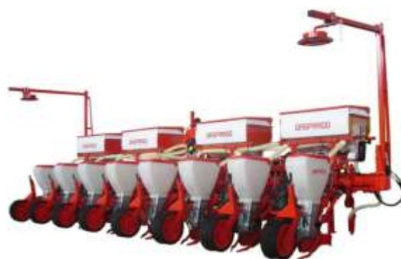
Универсальная пневматическая сеялка Гаспардо (Gaspardo) SP8
