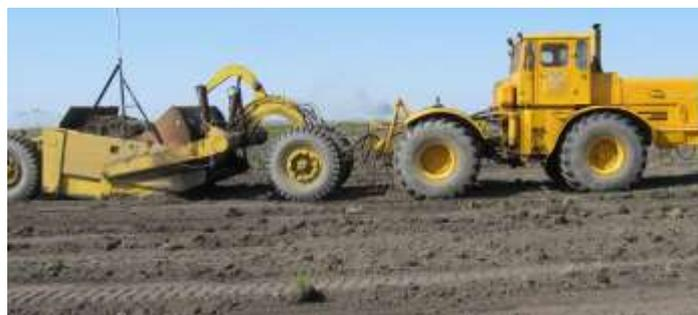
**Скрепер ДЗ-77 с лазерно-приемным устройством
