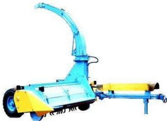
Комбайн прицепной роторный с кормоизмельчителем «ВОЛГА-2»
