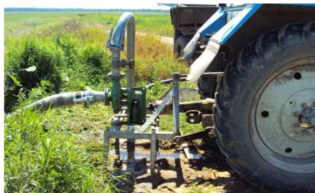
Подключение помпы к трактору МТЗ 82
