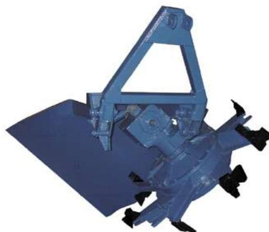
**Каналокопатель плужно-роторный МК-23**
