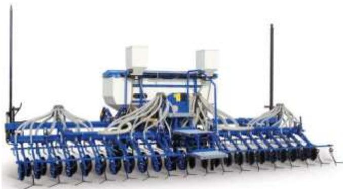
Сеялка зерновая пневматическая СЗП-400
