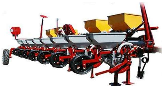
Сеялка точного высева СТВ-8К
