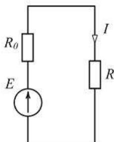
Выделяющаяся в нагрузке с сопротивлением  $R$  мощность  $P$  равна ...
