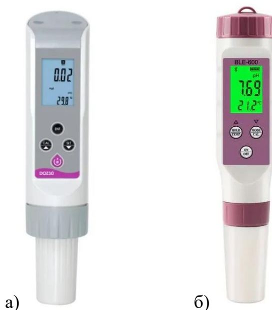
Рисунок 3.3 – Фотографии используемых в эксперименте измерительных приборов для определения концентрации озона в анолите (а), pH и температуры (б)
