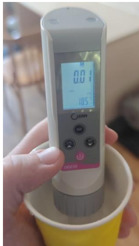
Рисунок 3.5 – Фотография процесса измерения концентрации растворенного озона в анолите при Q = 0,75 л/мин
