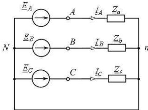
В изображенной схеме с симметричной системой ЭДС  $\underline{E}_A, \underline{E}_B, \underline{E}_C$  соотношение  $U_L = \sqrt{3}U_\phi$  выполняется \_\_\_\_\_ нагрузке (нагрузках).
