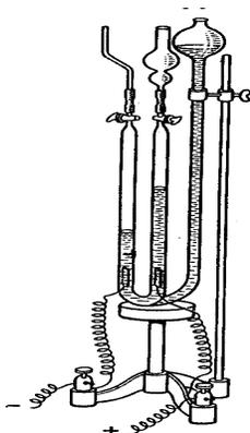
При пользовании вольтметром Гофмана водород обнаруживается поджиганием, а кислород — воспламенением тлеющей лучинки.
