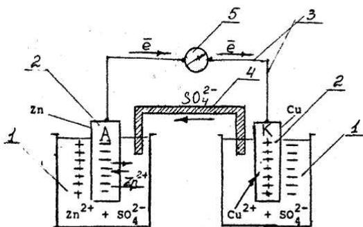
Два стакана на  $200 \text{ см}^3$  (1), электроды (2), соединительные провода (3), электролитный мостик (4), гальванометр (5).
