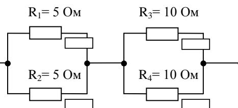
5. Определить потери мощности  $P$  на элементе цепи
