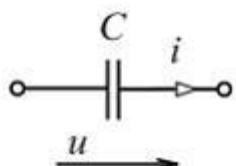
В изображенной схеме угол сдвига фаз между напряжением  $u$  и током  $i$  равен \_\_\_\_\_ радиан.
