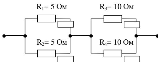
5. Определить потери мощности  $P$  на элементе цепи
