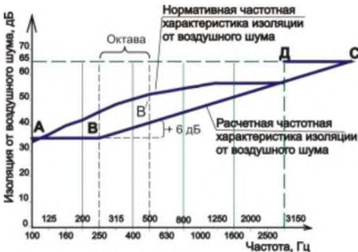
Рисунок 1 - Схема к расчету звукоизоляции перегородки
