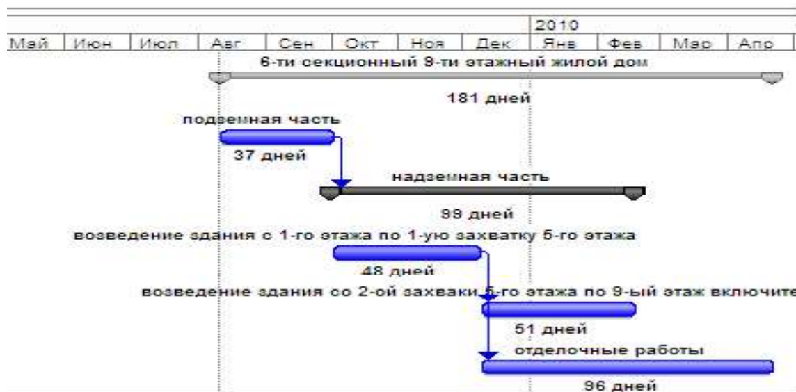
Рис. 2.9. Технологическая последовательность выполнения комплексов работ по возведению 6-секционного 9-этажного жилого дома
