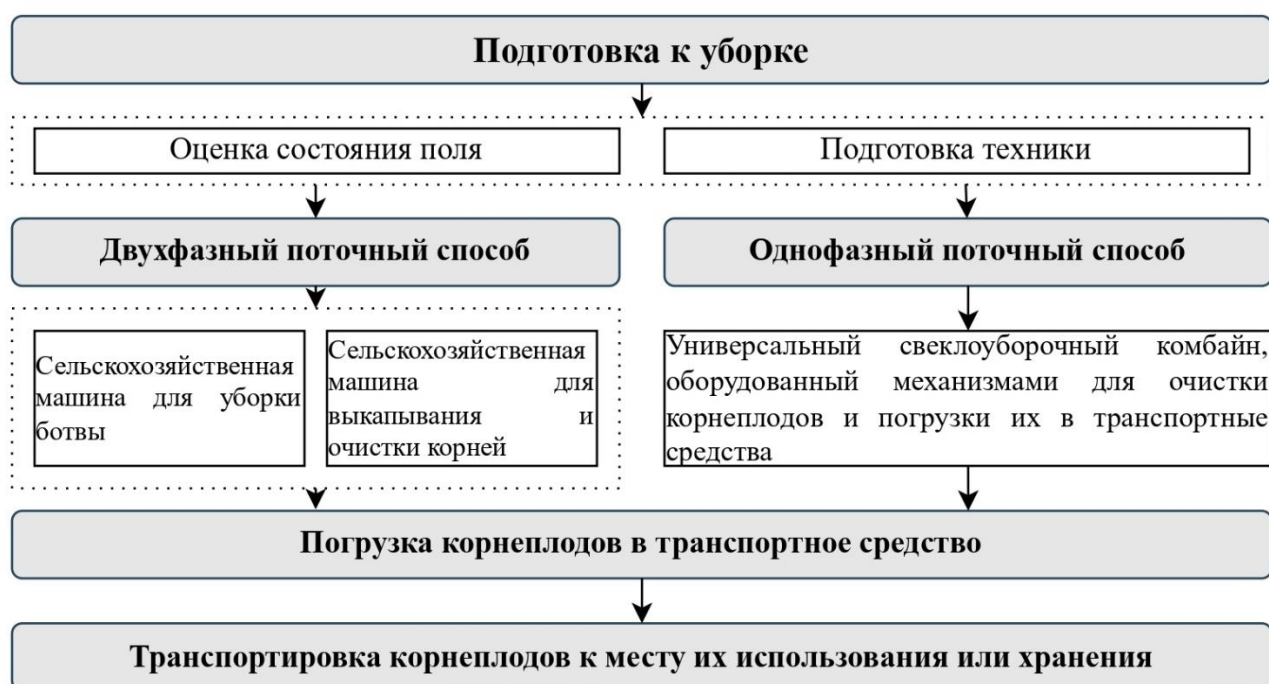
Рисунок 40 – Схема уборки сахарной свеклы по поточной технологии [составлено автором]
