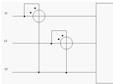
a)  $P_{\Sigma} = \sqrt{3} * (P_{w1} + P_{w2})$  б)  $P_{\Sigma} = \sqrt{3} * (P_{w1} - P_{w2})$  в)  $P_{\Sigma} = P_{w1} + P_{w2}$  г)  $P_{\Sigma} = P_{w1} - P_{w2}$
