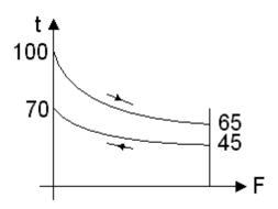
Наибольша разность температур для противоточной схемы движения теплоносителей, представленьюй на рисунке, равна $\__{0}^{0}$ С
