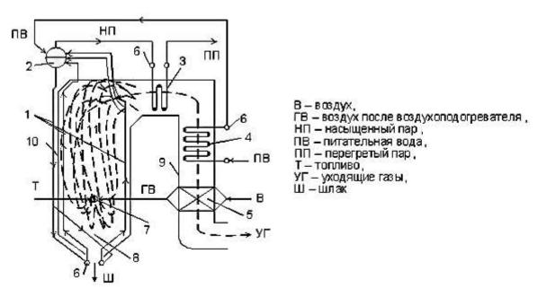
Пароперегреватель вертикально-водотрубного барабанного парового котла
