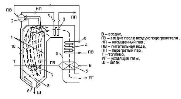
Современный вертикльно- водотрубный барабанный паровой котел с...
