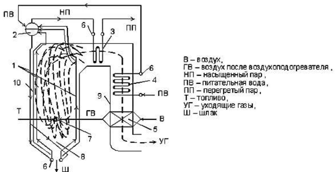
Пароперегреватель вертикально-водотрубного барабанного парового котла
