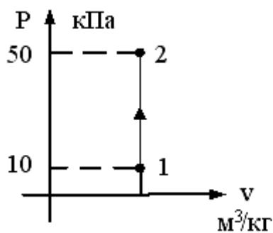
$T_1 = 100$  К. В точке 2 изохорного процесса, представленного на графике, температура равна \_\_\_\_ К.
