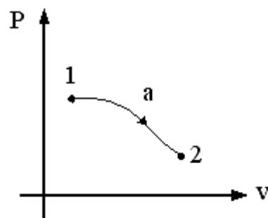
Если  $P_1 = 3 \cdot P_2$ ,  $v_1 = v_2/3$ , то изменение энталпий  $\Delta h = h_1 - h_2$  в процессе 1-2, показанном на графике, равно...
