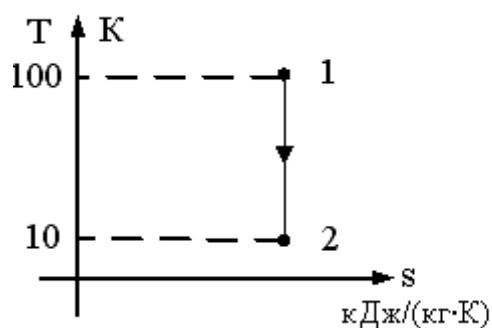
$T_1 = 100\text{K}$ ,  $T_2 = 10\text{K}$ ,  $\Delta v_1 = 1 \text{ m}^3/\text{kg}$ ,  $k = 2$ . В точке 2 адиабатного процесса, представленного на графике, удельный объем равен....
