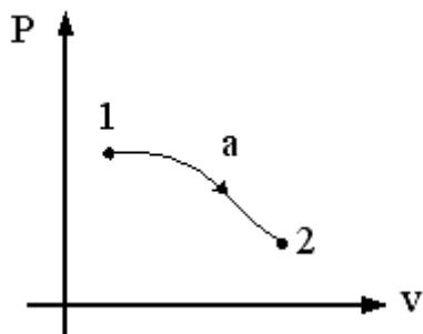
Если  $P_1 = 3 \cdot P_2$ ,  $v_1 = v_2/3$ , то изменение энталпий  $\Delta h = h_1 - h_2$  в процессе 1-2, показанном на графике, равно...
