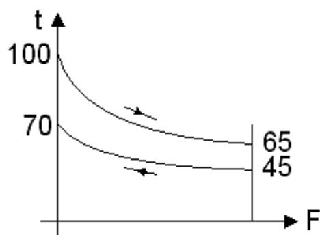
Наибольшая разность температур для противоточной схемы движения теплоносителей, представленной на рисунке, равна \_\_\_°C
