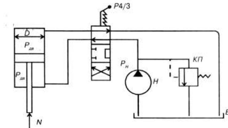
Рисунок 1 – Схема объемного гидропривода
