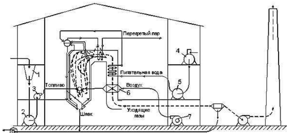
Холодный воздух подается вентилятором в воздухоподогреватель, обозначенный на рисунке цифрой...
