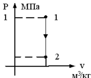
$T_1 = 1000\text{K}$ ,  $T_2 = 100\text{K}$ ,  $P_1 = 1 \text{ MPa}$ . В точке 2 изохорного процесса, представленного на графике, давление равно...
