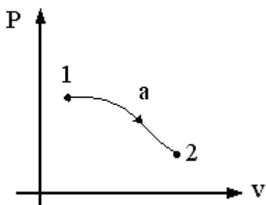
Если  $P_1 = 3 \cdot P_2$ ,  $v_1 = v_2/3$ , то изменение энталпии  $\Delta h = h_1 - h_2$  в процессе 1-2, показанном на графике, равно...
