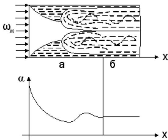
При расчете средней теплоотдачи от стенки трубы к протекающему по ней теплоносителю, изображенном на рисунке, за определяющий размер принимается...
