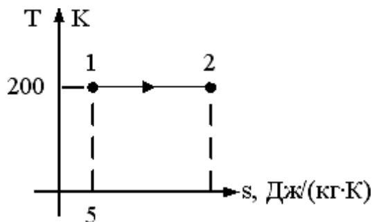
Если количество теплоты, которое подводится в изометрическом процессе 1 -2 равно 500 Дж/кг, то энтропия в точке 2 равна...
