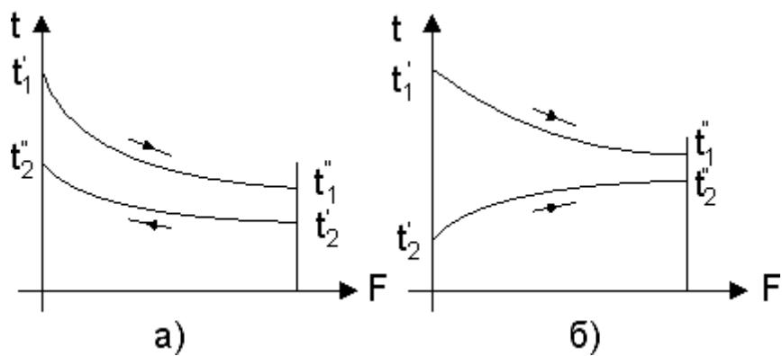
На рис. а) представлен график изменения температур теплоносителей при противоточной схеме, на рис. б)- при прямоточной.
