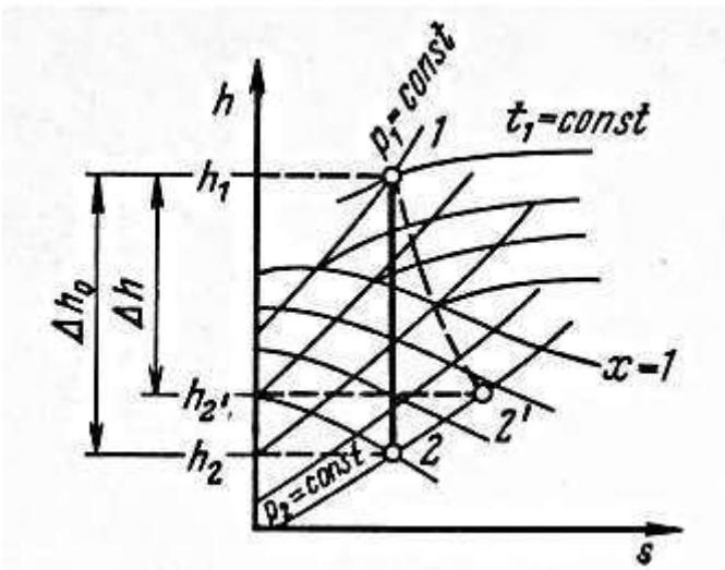
Соотношение между сухости пара в конце процессов равновесного и неравновесного расширения пара в сопле, представленном на графике, равно...
