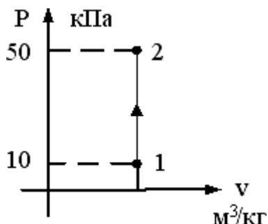
$T_1 = 100 \text{ K}$ . В точке 2 изохорного процесса, представленного на графике, температура равна \_\_\_\_ K.
