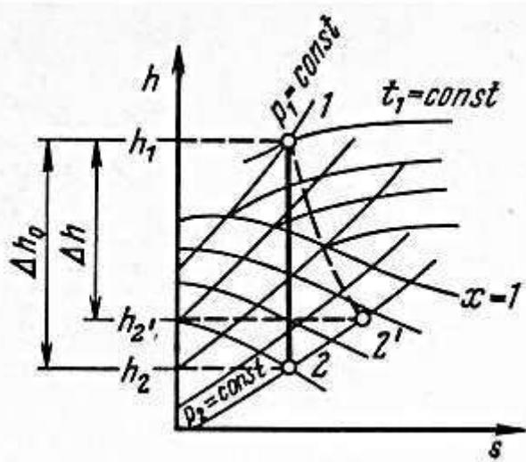
При одинаковом перепаде давления  $P_1 - P_2$  соотношение между разностью энталпий в равновесном  $\Delta h_0$  и неравновесном  $\Delta h$  процессах расширения пара в сопле, представленных на графике, имеет вид...
