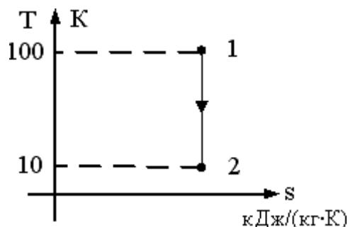
$T_1 = 100\text{K}$ ,  $T_2 = 10\text{K}$ ,  $v_1 = 1 \text{ m}^3/\text{кг}$ ,  $k = 2$ . В точке 2 адиабатного процесса, представленного на графике, удельный объем равен....
