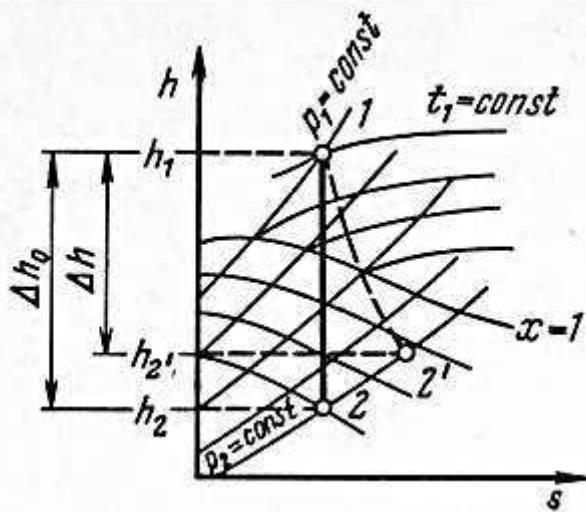
При одинаковом перепаде давления  $P_1 - P_2$  соотношение между скоростями истечения пара в сопле в равновесном  $C_2$  процессах, представленных на графике, имеет вид....
