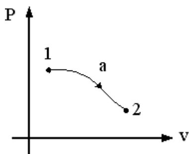
Если  $P_1 = 3P_2$ ,  $v_1 = v_2/3$ , то изменение энталпий  $\Delta h = h_1 - h_2$  в процессе 1-2, показанном на графике, равно...
