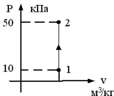
$T_1 = 100 \text{ K}$ . В точке 2 ихорного процесса, представленного на графике, температура равна \_\_\_ K.
