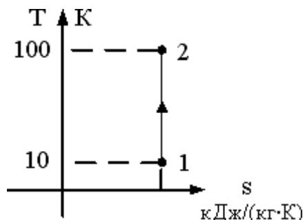
$T_1 = 10 \text{ K}$ ,  $T_2 = 100 \text{ K}$ ,  $P_1 = 1 \text{ кПа}$ ,  $\kappa=2$ . В точке 2 адиабатного процесса, представленного на графике, давление равно\_\_\_\_кПа.
