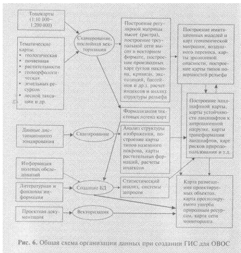
Рис. 6. Общая схема организации данных при создании ГИС для ОВОС
