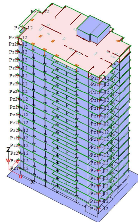
Рисунок 2.66 – Заданная ветровая нагрузка на каркас здания
