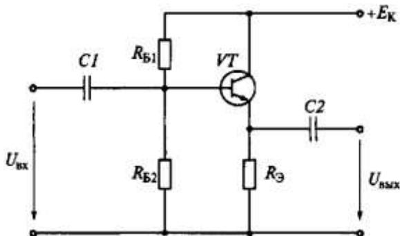
5 Рассчитайте сопротивление резистора  $R_B$ , при котором рабочая точка будет находиться на середине линейных участков входной и выходной характеристик, если  $E_K=10$  В и  $R_K=1$  кОм. Определите коэффициенты усиления по напряжению  $K_U$ , по току  $K_I$  и по мощности  $K_P$ , а также входное  $R_{\text{вх}}$  и выходное  $R_{\text{вых}}$  сопротивления усилительного каскада. Принять  $h_{11}=330$  Ом,  $h_{21}=46$ ,  $h_{22}=10^{-4}$  См, значение  $h_{12}$  принять равным нулю.
