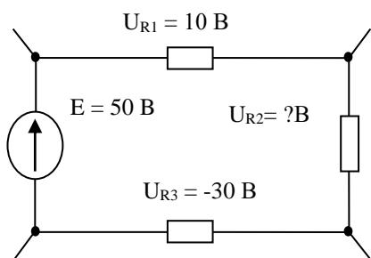
8. Определить мощность, потребляемую схемой
