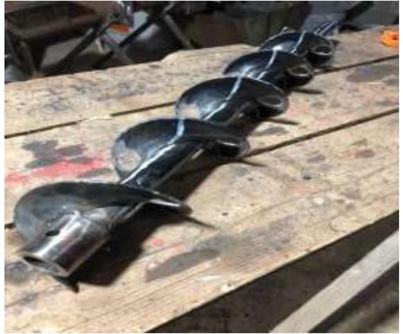
Рисунок 3 – Общий вид шнековой мешалки с пересыпными отверстиями
