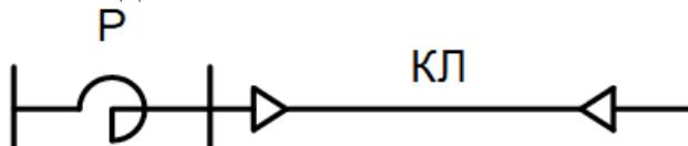
$$\text{Р: } x_{\text{Р}} = 0,45 \text{ Ом, } I_{\text{Н}} = 1000 \text{ А, } U_{\text{Н}} = 10 \text{ кВ;} \\ \text{КЛ: } l = 2 \text{ км, } x_0 = 0,08 \text{ Ом/км.}$$
