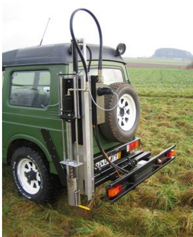
Рисунок 9.1 – Пробоотборник почвы N 2000 (фирма Bodenprobetechnik Nietfeld, Германия)
