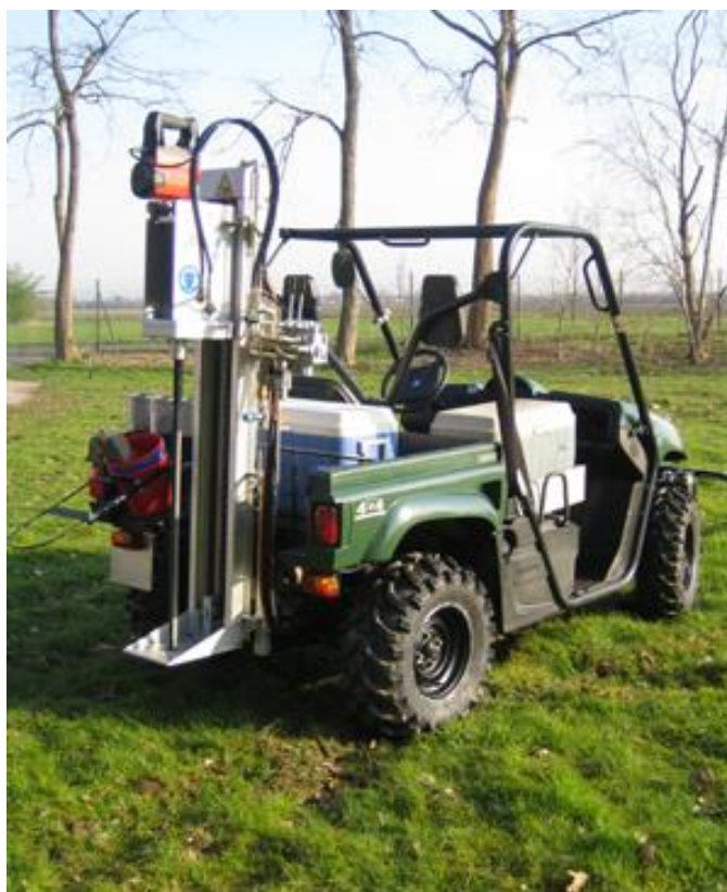
Рисунок 9.2 – Пробоотборник почвы NH 90
