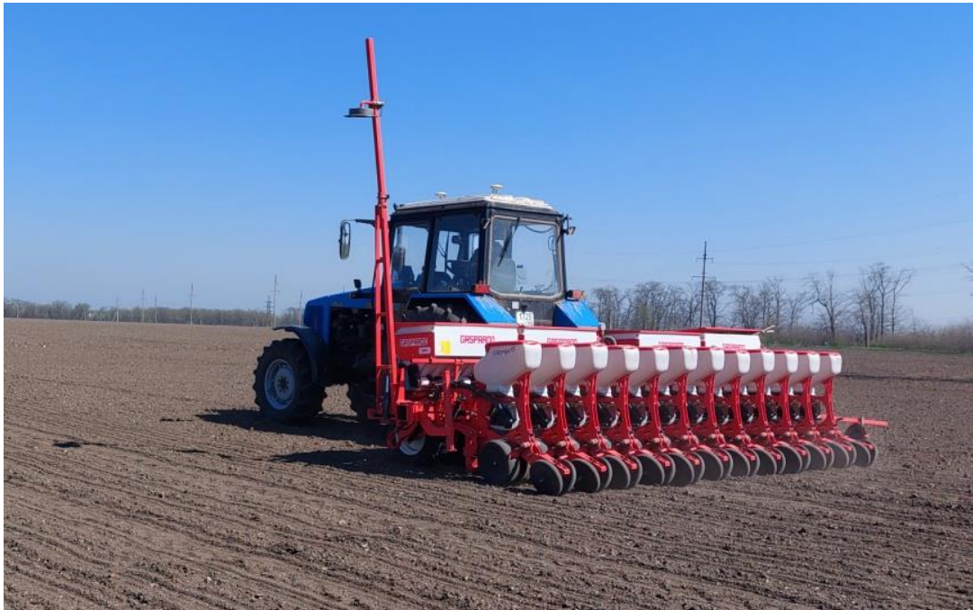
Рисунок 15 – Посев опыта трактором БЕЛАРУС 1221.3 и пневматической сеялкой GASPARDO MTR 12
