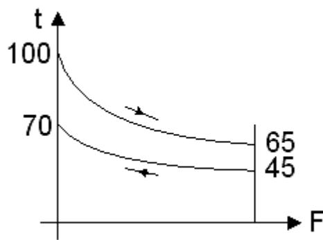
Наибольшая разность температур для противоточной схемы движения теплоносителей, представленной на рисунке, равна \_\_\_\_°С
