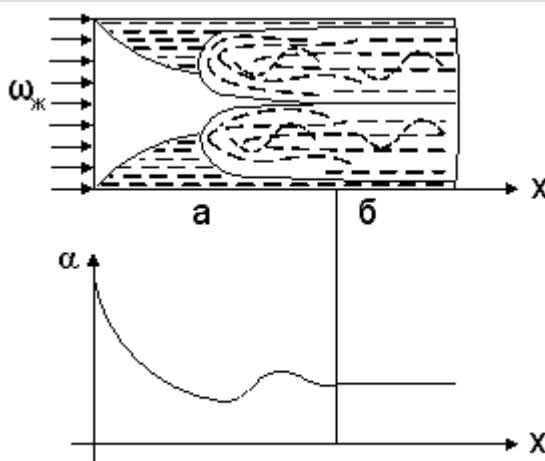
При расчете средней теплоотдачи от стенки трубы к протекающему по ней теплоносителю, изображеному на рисунке, за определяющий размер принимается...
