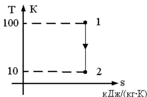
$T_1 = 100\text{K}$ ,  $T_2 = 10\text{K}$ ,  $v_1 = 1 \text{ m}^3/\text{kg}$ ,  $k = 2$ . В точке 2 адиабатного процесса, представленного на графике, удельный объем равен....
