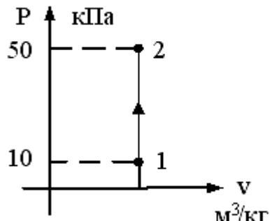
$T_1 = 100 \text{ K}$ . В точке 2 изохорного процесса, представленного на графике , температура равна \_\_\_\_\_ К.
