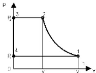
На теоретической индикаторной диаграмме поршневого компрессора, показанной на графике, работа, затрачиваемая, на получение 1 кг сжатого газа, изображается площадью....
