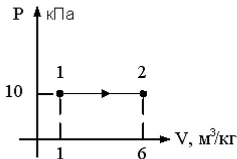
Работа расширения идеального газа в процессе 1-2, изображенном на графике, в Дж/кг равна...
