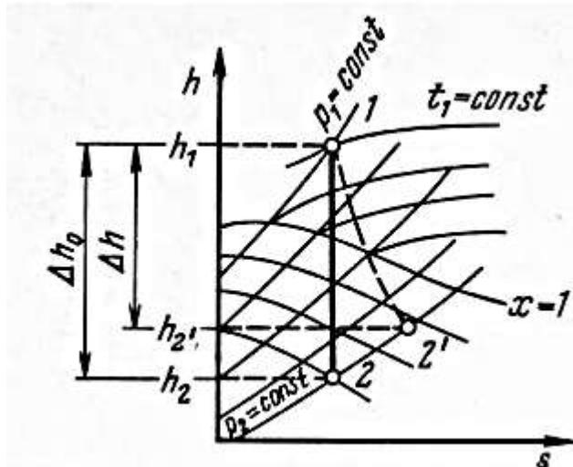
Соотношение между сухости пара в конце процессов равновесного и неравновесного расширения пара в сопле, представленном на графике, равно...
