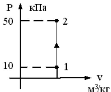
$T_1 = 100$  К. В точке 2 изобарного процесса, представленного на графике, температура равна\_\_\_\_К.
