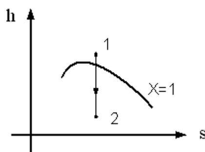
Работа расширения пара в процессе 1-2, изображенном на графике, вычисляется по формуле....
