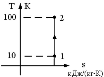
$T_1 = 10$  К,  $T_2 = 100$  К,  $P_1 = 1$  кПа,  $\kappa = 2$ . В точке 2 адиабатного процесса, представленного на графике, давление равно\_\_\_\_кПа.
