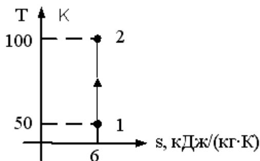
Подводимая теплота в процессе 1-2 идеального газа, изображенном на графике, в Дж/кг равна...
