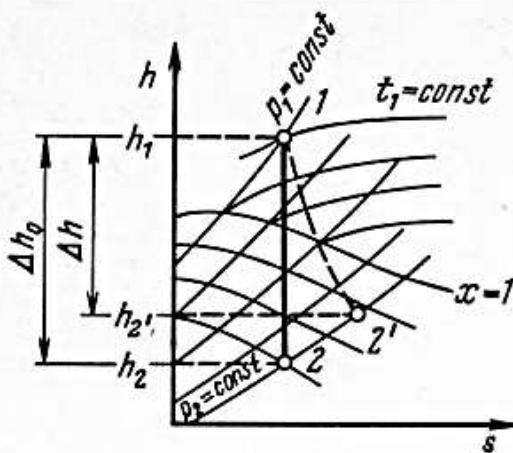
При одинаковом перепаде давления  $P_1 - P_2$  соотношение между разностью энталпий в равновесном  $\Delta h_0$  и неравновесном  $\Delta h$  процессах расширения пара в сопле, представленных на графике, имеет вид...
