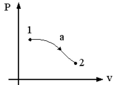
Если  $P_1 = 3 \cdot P_2$ ,  $v_1 = v_2/3$ , то изменение энталпий  $\Delta h = h_1 - h_2$  в процессе 1-2, показанном на графике, равно...
