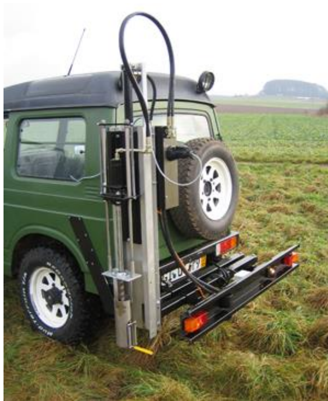
Рисунок 3.127 – Пробоотборник почвы N 2000 (фирма Bodenprobetechnik Nietfeld, Германия)
