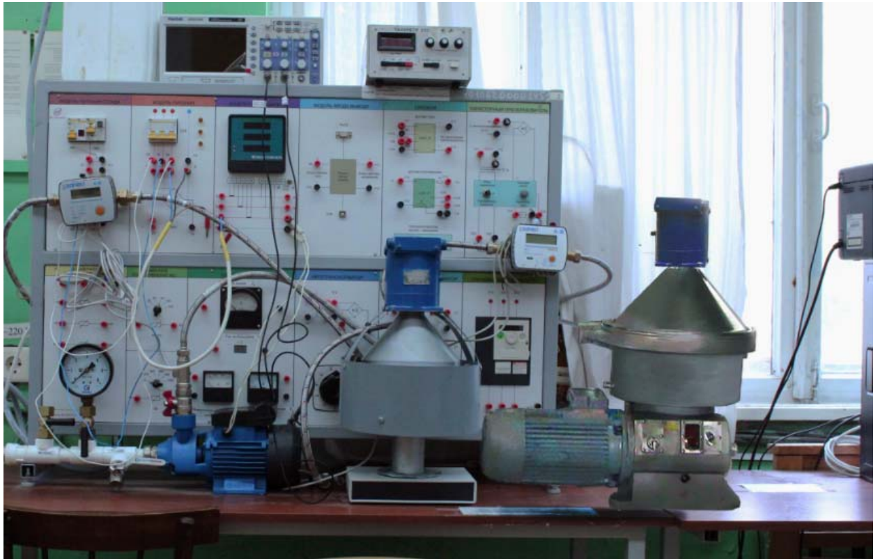
Рисунок 3.15 – Внешний вид лабораторного стенда для экспериментальных исследований натурной модели БЭСМ мощностью 4 кВт
