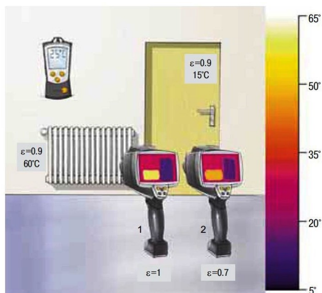
Рисунок 1.2 – Влияние некорректной настройки коэффициента излучения на результаты измерения температуры
