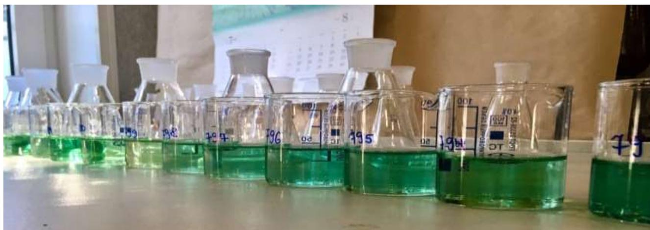
Рисунок 12 – Определение аммонийного азота в почве
