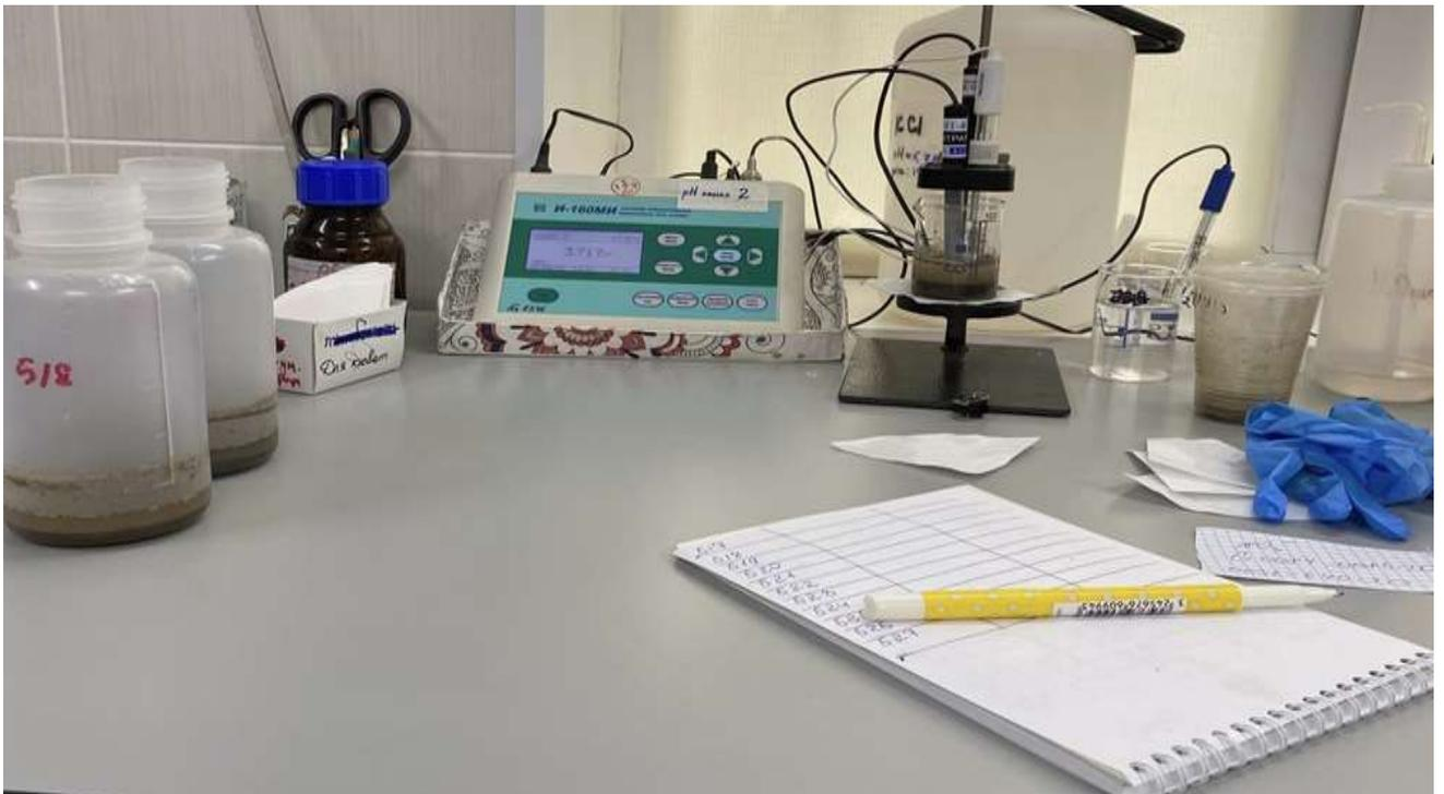
Рисунок 14 – Определение pH солевой вытяжки почвы
