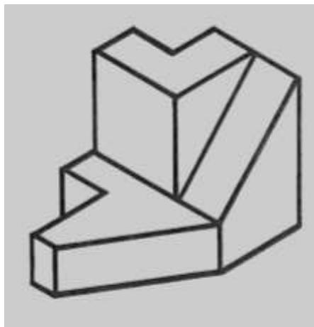
↓ Вычертить по данным своего варианта (наглядной детали) три основных вида детали. (главный, вид сверху и вид слева). Помнить, что построение видов выполняется в строгой проекционной связи. Для правильной компоновки чертежа, расстояние между главным видом детали и видом сверху рекомендуется принять не менее 50мм, между главным видом и видом слева – 30мм.
