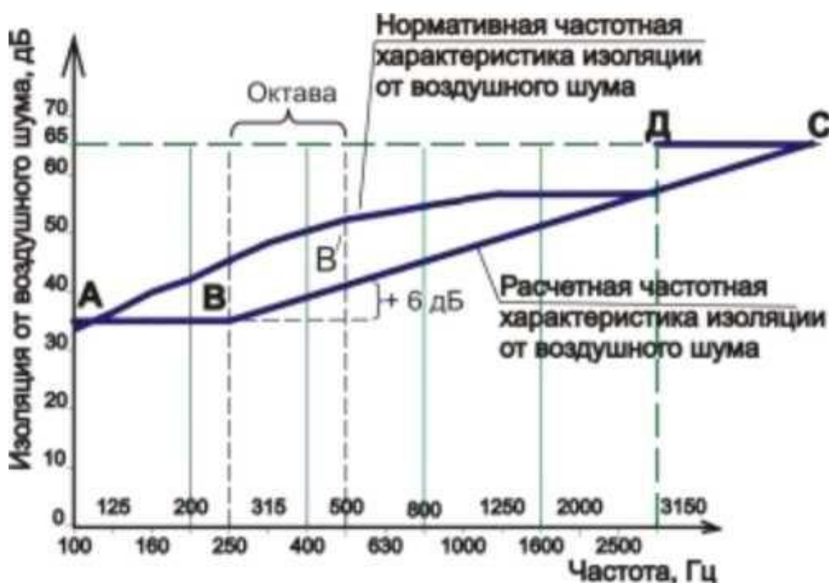
Рисунок 1 - Схема к расчету звукоизоляции перегородки
