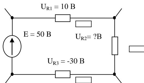
8. Определить мощность, потребляемую схемой
