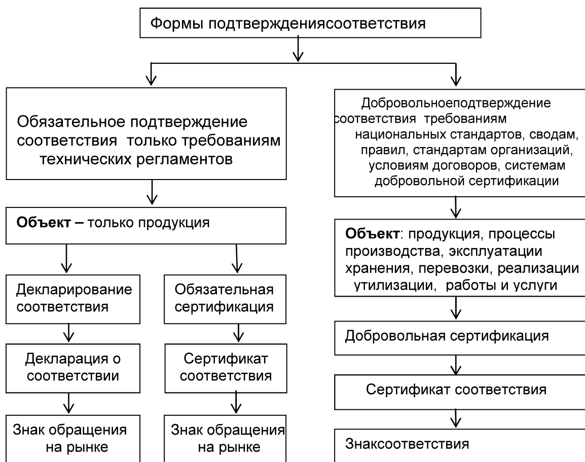
Рис. 12. Схема форм подтверждения соответствия по ФЗ «О техническом регулировании»
