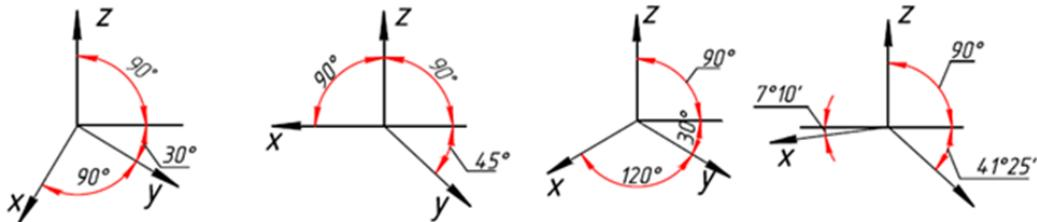
28 Координатные оси в прямоугольной диметрии располагаются относительно друг друга
