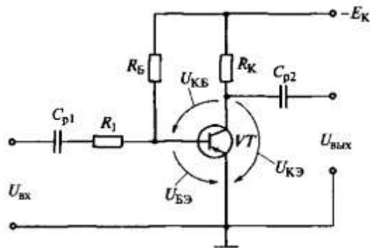
3 В транзисторе марки КТ315А, включенном по схеме с общим эмиттером, ток базы изменился на 0,1 мА. Как при этом изменится ток эмиттера, если коэффициент усиления  $\alpha=0,975$ ?
