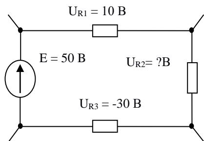
8. Определить мощность, потребляемую схемой
