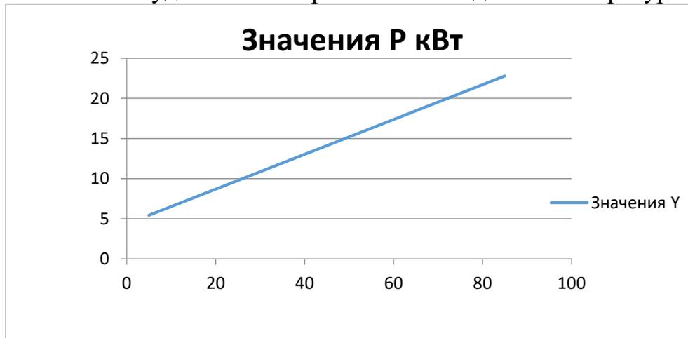
Зависимость мощности водонагревателя от температуры воды.
