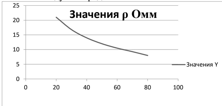
Зависимость удельного сопротивления воды от температуры
