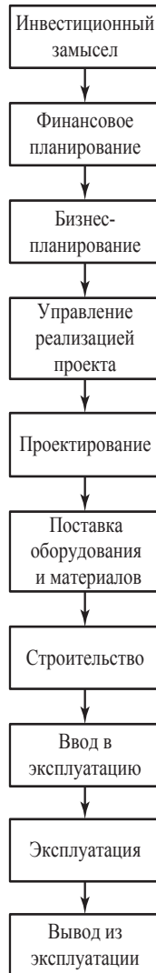
Рис. 2. Схема базового инвестиционно-строительного процесса [10]
