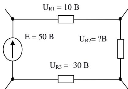
8. Определить мощность, потребляемую схемой
