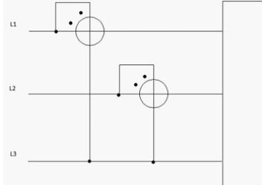
$$a) P_{\Sigma} = \sqrt{3} * (P_{w1} + P_{w2}) \quad 6) P_{\Sigma} = \sqrt{3} * (P_{w1} - P_{w2}) \quad b) P_{\Sigma} = P_{w1} + P_{w2} \quad \Gamma) P_{\Sigma} = P_{w1} - P_{w2}$$
