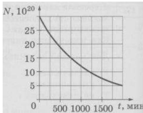
**Задание 18** На рисунке представлен график изменения числа ядер находящегося в пробирке радиоактивного изотопа с течением времени. Каков период полураспада этого изотопа?
