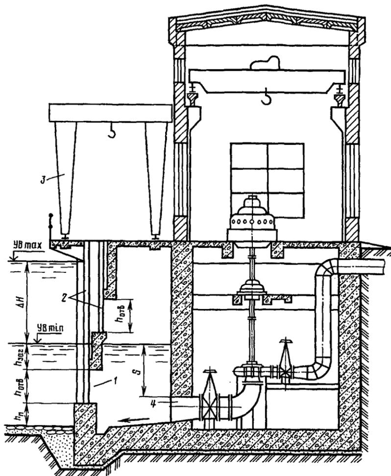
водоприемное отверстие обозначено цифрой [1]
