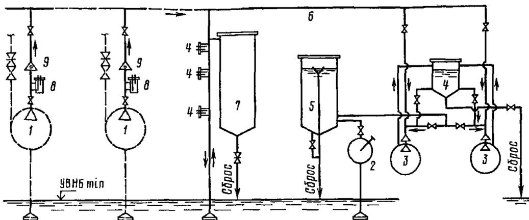
заливочный бачок-отстойник обозначен цифрой [5]
