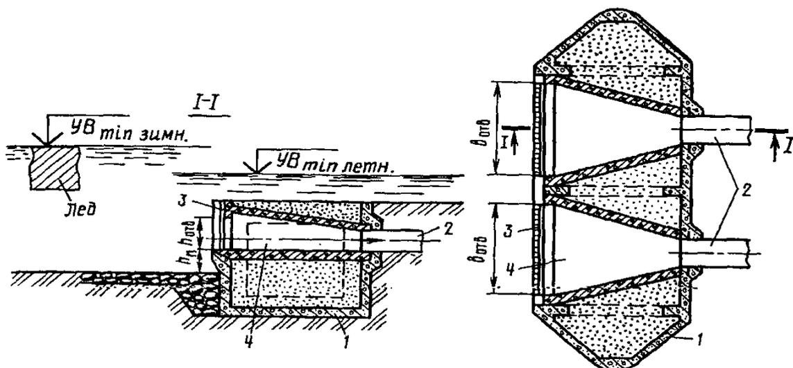
железобетонный кожух, заполняемый гравием или бетоном, обозначен цифрой [1]
