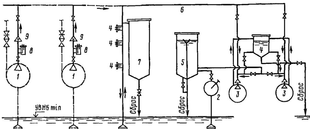
основной и ручной насосы обозначены цифрами [1 и 2]
