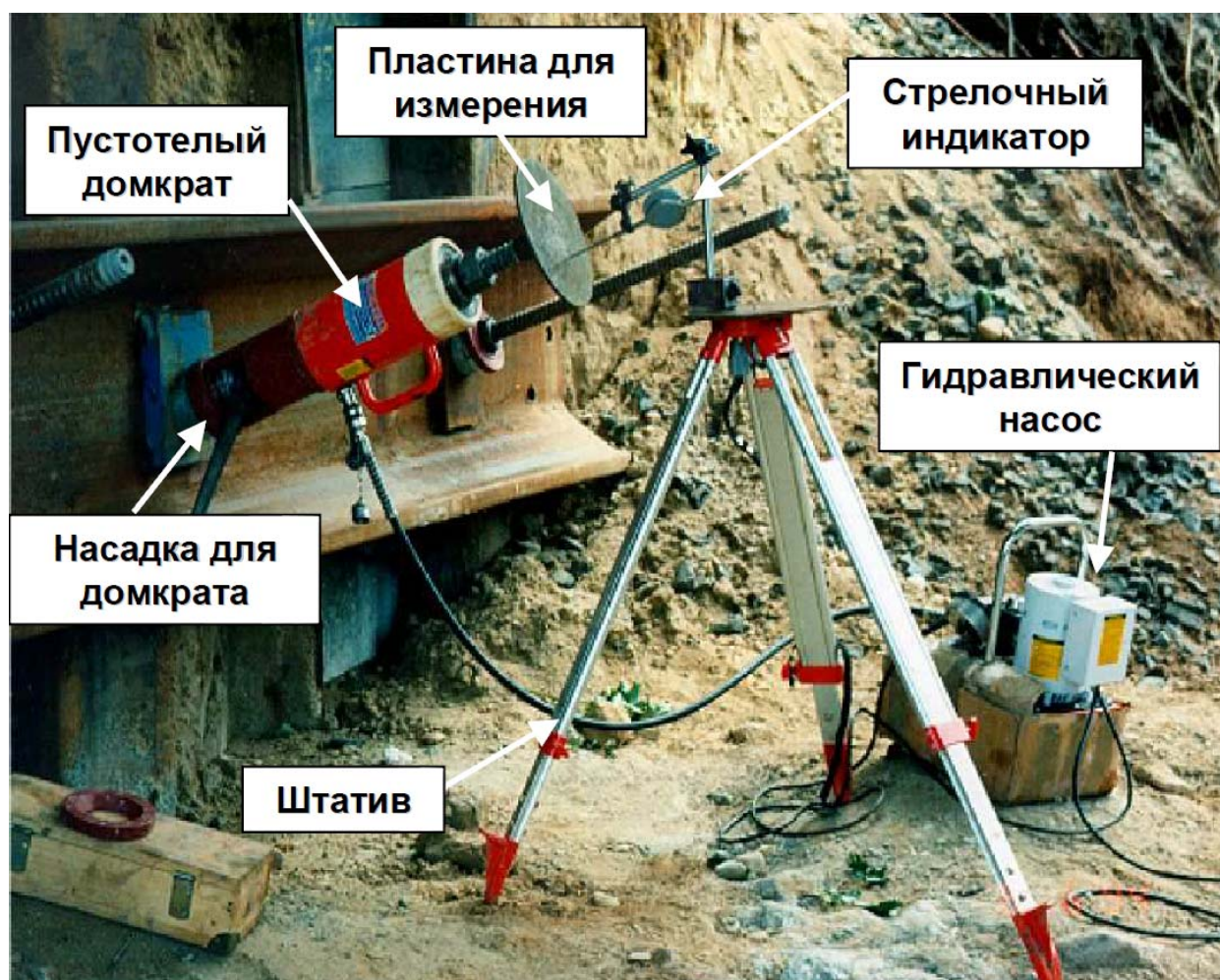
Рисунок 3.9 – Приборы для проведения испытаний анкерных свай
