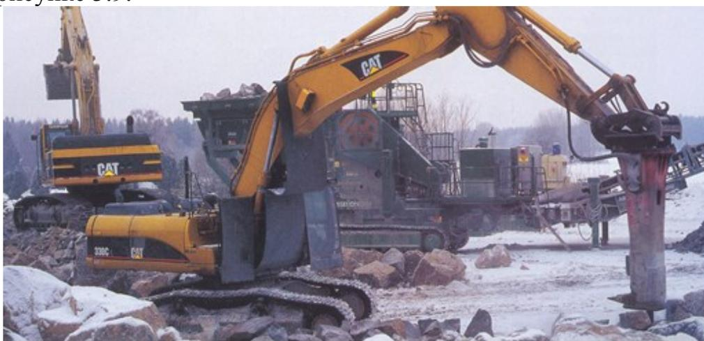
Рисунок 3.9 – Дробление крупных каменных глыб посредством гидромолота
