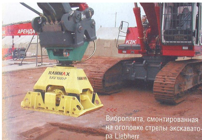
Рисунок 3.15 – Машина на базе экскаватора с жесткой подвеской стрелы для уплотнения грунта вибрацией
