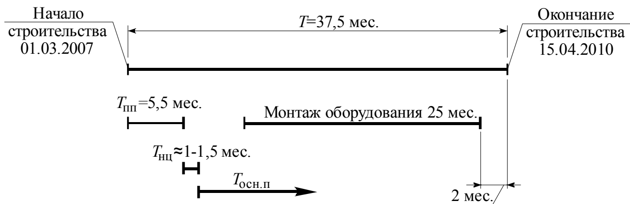
Рис. 1. Продолжительность строительства объекта (пример)
